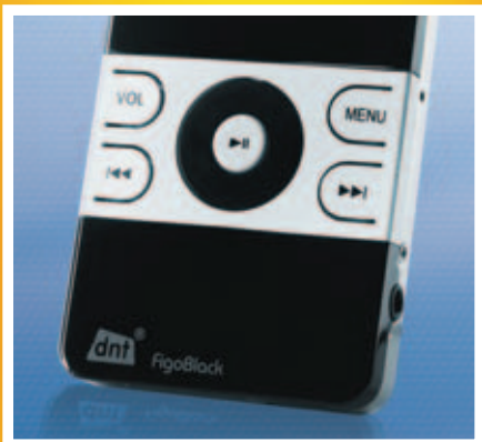
Beim Figo Black 10 von DNT sind die Tastenfelder scharfkantig ausgefräst. Daher ist für die Bedienung Vorsicht vor Versehentlichem Hochbiegen geboten.
