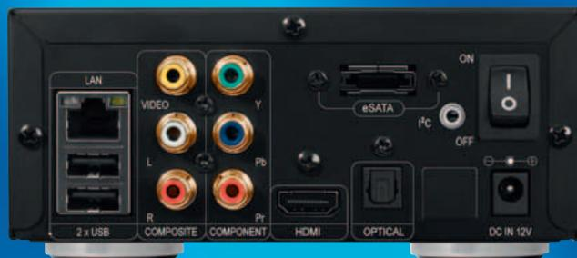
Die Rückseite des hochwertig verarbeiteten Dune HD Smart B1 enthält auch die schnelle eSATA-HDD-Schnittstelle.
